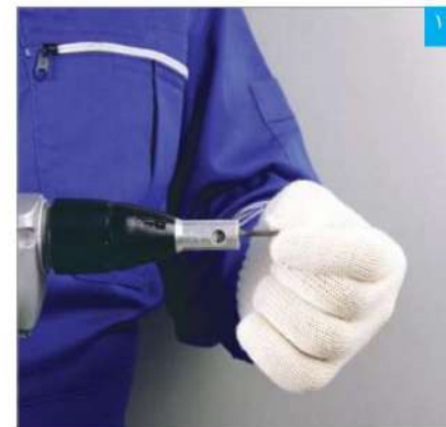
برای نصب پنل‌ها از پیچ مخصوص و دستگاه پیچ زن استفاده می‌شود
